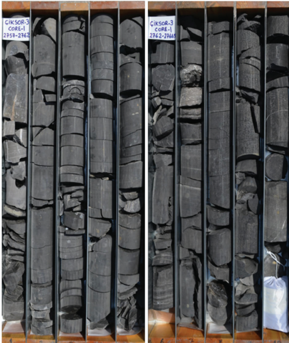
Şekil 27. Dadaş Formasyonu'nun tabanını oluşturan siyah renkli, organik madde yönünden çok zengin kaynak kaya şeyl fasiyesi bazı arama kuyulardan alınan karotlarda incelenmiştir (Şenalp vd., 2018).
